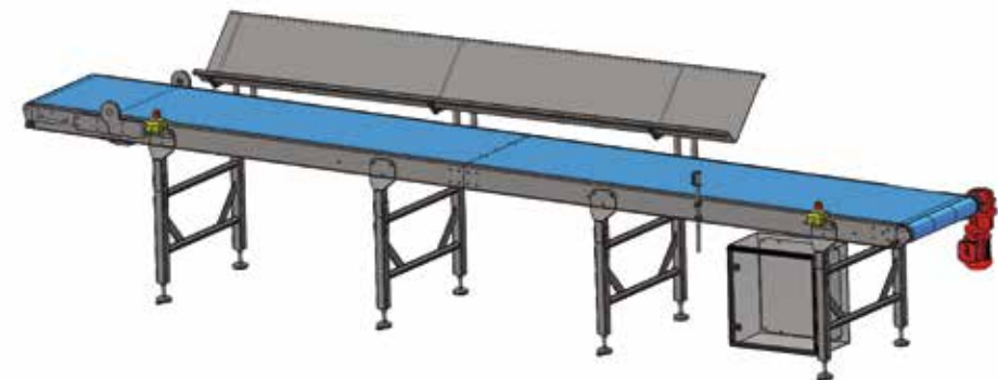
» Abb. 5 – Gerader Gurtförderer 3D Zeichnung
